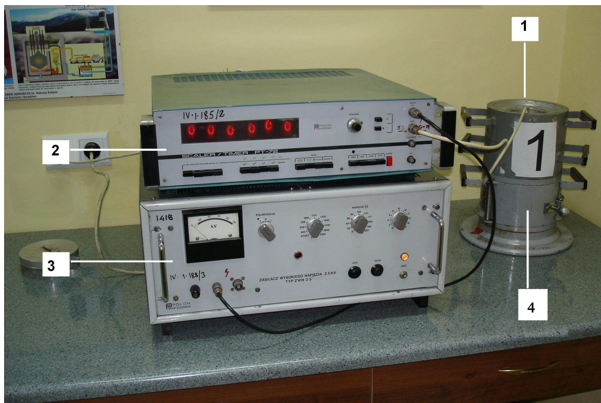
Fot. 1. Aparatura pomiarowa stosowana w niniejszym ćwiczeniu: 1 - Licznik kielichowy G-M, 2 - Przelicznik PT-72, 3 - Zasilacz wysokiego napięcia ZWN 2.5, 4 - domek radiochemiczny.
